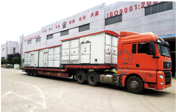
中蒙塞尔维亚拖拽移动变电站预制舱
